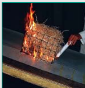
Brandproef ENV1187/1 ontsteking.
